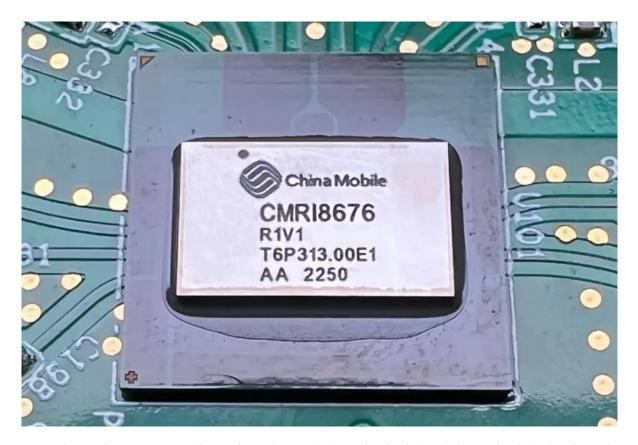
据"破风8676"技术总工中国移动研究院首席专家王大鹏介绍称,为 适配多频段、多模式、多站型的应用需求, 研发团队创新性提出可重构技 术架构, 支持信号带宽、杂散抑制频点和深度等重要规格参数灵活匹配, 数字预失真、削峰等模块算法灵活调整,基带成型滤波、均衡滤波等增量 功能灵活加载,利用这些架构优化和功能重组,以系统集成创新,弥补单 点性能瓶颈, 打造了一款达到国际先进水平, 同时具备低成本、低功耗、 多功能等差异化竞争优势的产品。
