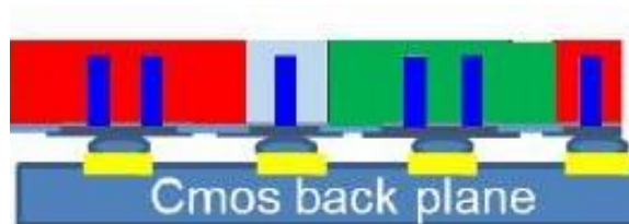
图 2-3 采用蓝光纳米线加色彩转换层形成彩色 Micro-LED 的示意图
