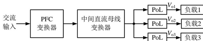
图 4.5 分布式服务器电源系统结构图
