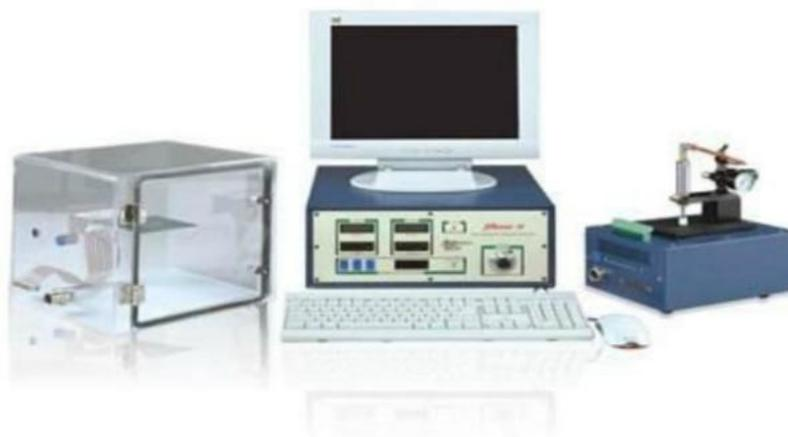
图 2-15 PHASE 11 热阻与安全工作区域测试系统
