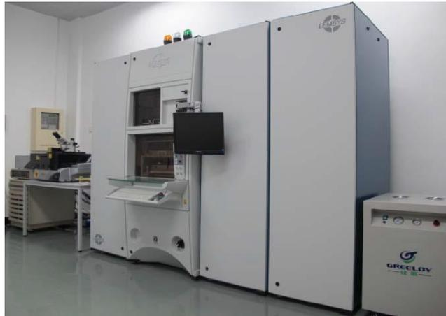
图 4-3 中科院电工所的动静态参数测试仪
