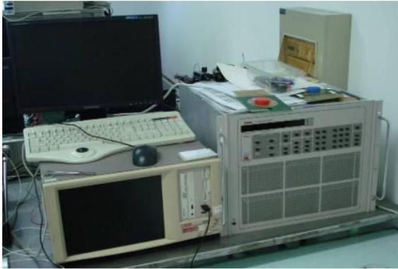
图 3-5 半导体参数测试仪 4200
