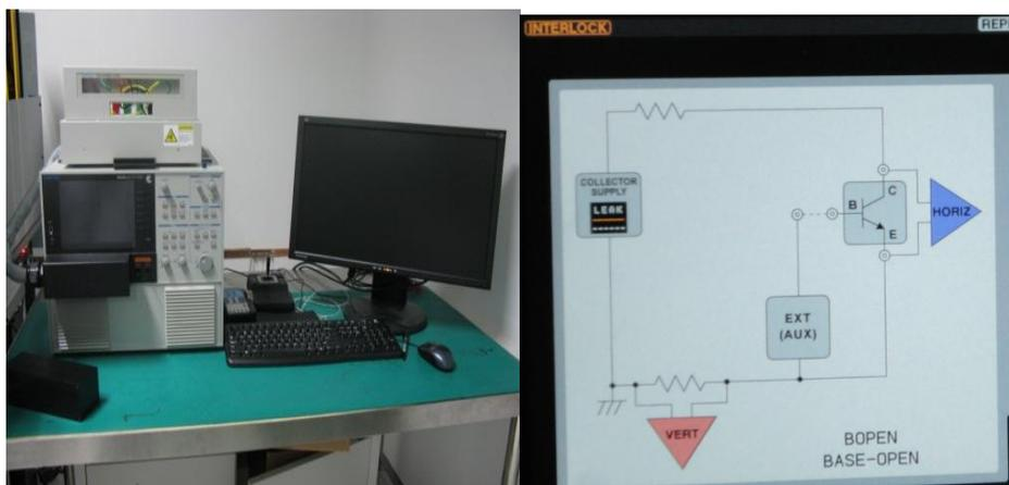
图 2-2 静态参数测试系统示意图
