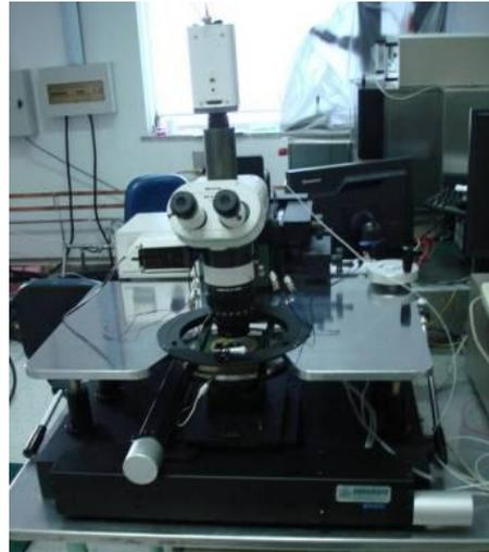
图 3-6 PW-800 手动探针台
