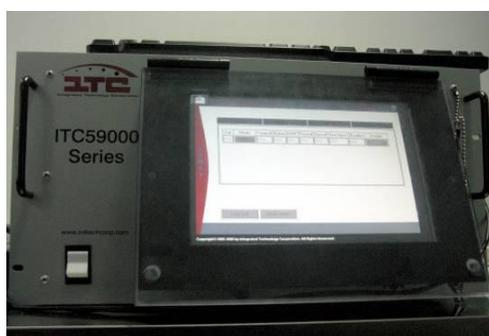
图 3-3 栅电荷测试系统
